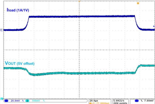
Figure 16. Load Transient, 0 <--> 285 mA, 8  $\mu\text{s}$  Edge
