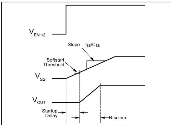
**FIGURE 4-4:** Soft-Start Waveforms.
