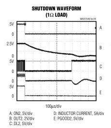
SHUTDOWN WAVEFORM (100 $\Omega$  LOAD)
