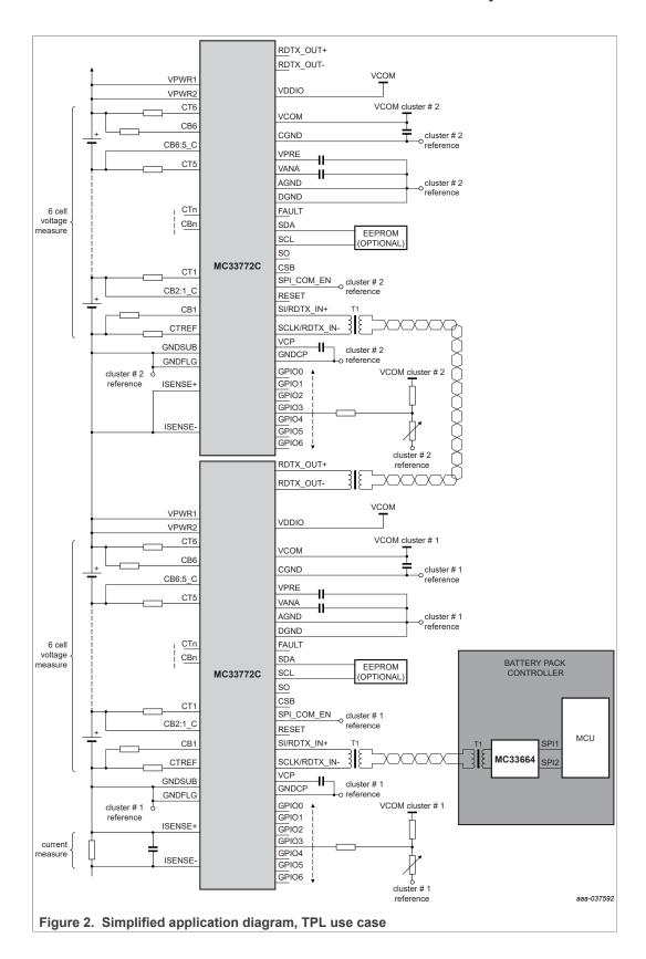
Battery cell controller IC
