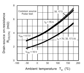
Fig. 8.9 R<sub>DS(ON)</sub> - T<sub>a</sub>
