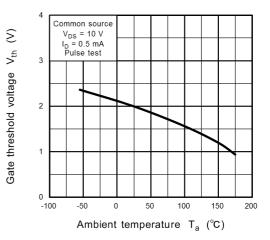
Fig. 8.12 V<sub>th</sub> - T<sub>a</sub>
