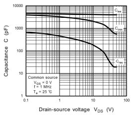
Fig. 8.13 Capacitance - V<sub>DS</sub>
