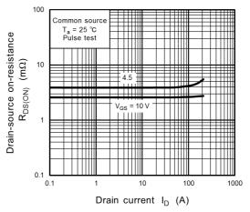
Fig. 8.8 R<sub>DS(ON)</sub> - I<sub>D</sub>
