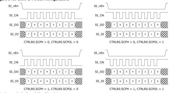
Figure 5-19. SIMC SPI Clock Configurations
