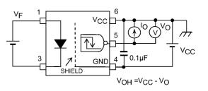
Fig. 12.1.2 V<sub>OH</sub> Test Circuit
