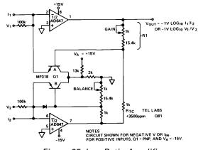
Figure 25. Log-Ratio Amplifier
