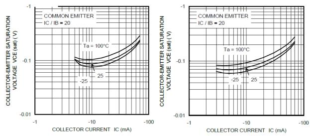
Fig. 10.19 RN2317 V<sub>CE(sat)</sub>-I<sub>C</sub>
