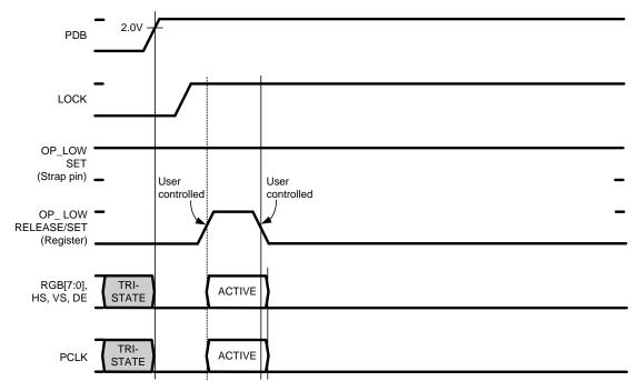
Figure 24. OP\_LOW Manual Set/Reset
