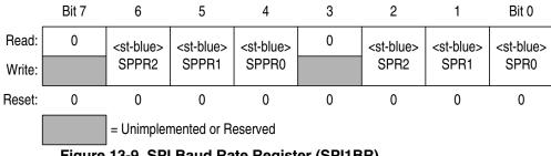
Figure 13-9. SPI Baud Rate Register (SPI1BR)
