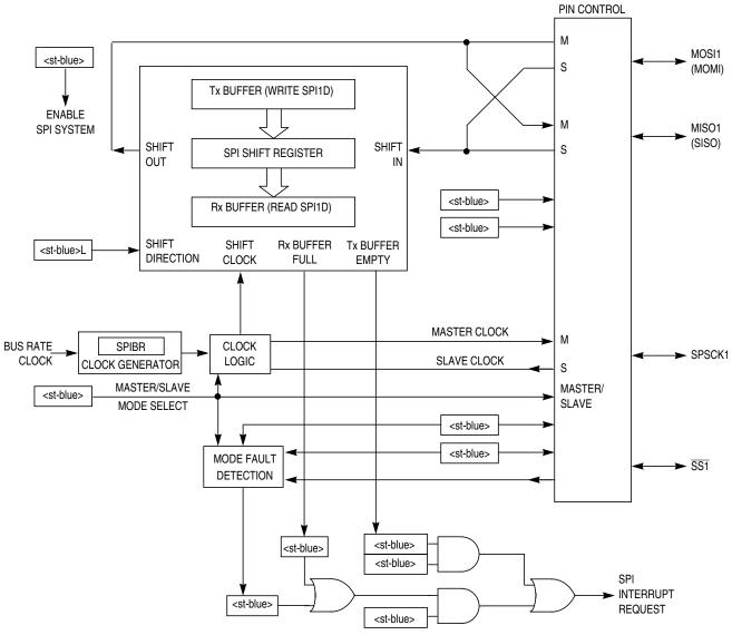
Figure 13-3. SPI Module Block Diagram
