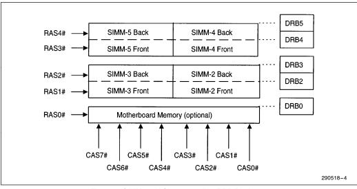
Figure 2. SIMMs and Corresponding DRB Registers
