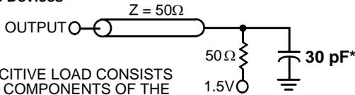
\* CAPACITIVE LOAD CONSISTS OF ALL COMPONENTS OF THE TEST ENVIRONMENT
