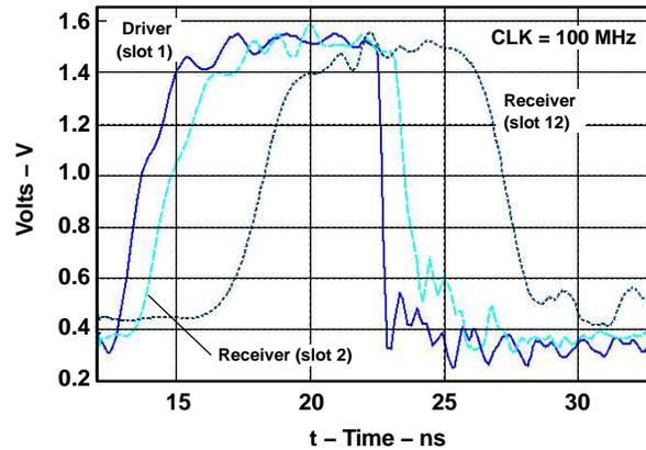
**Figure 5. Source-Synchronous Clock**
