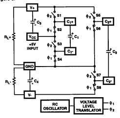
FIGURE 3. DUAL CHARGE PUMP
