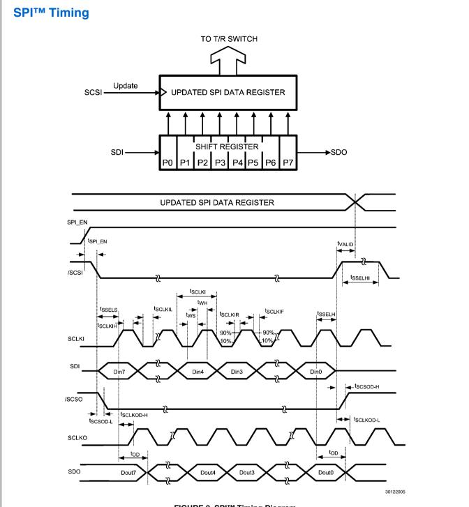
FIGURE 2. SPI™ Timing Diagram
