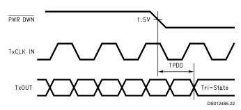
FIGURE 15. Transmitter Powerdown Delay
